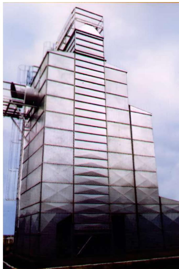
Secador contínuo para secagem de grãos em altas temperaturas.
