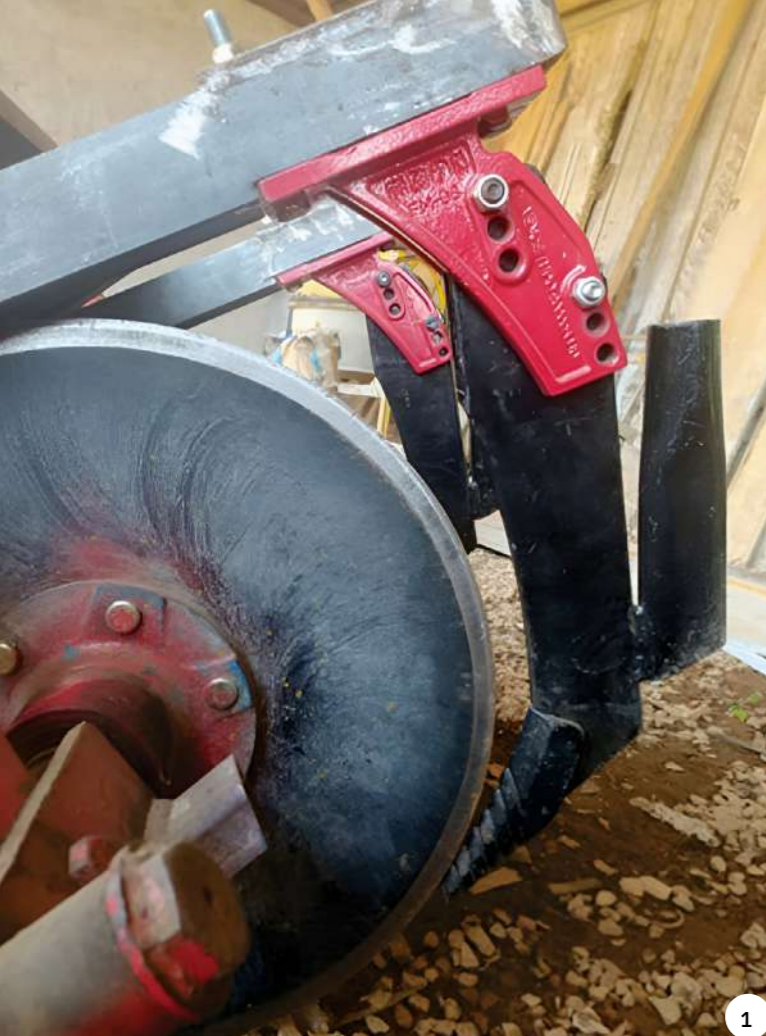
Equipamento montado em tratores de baixa potência, articulado, composto de rolo faca, discos de corte e hastes sulcadoras para operar em SPDH, validado em 2022 com os agricultores do Assentamento Filhos de Sepé, Viamão, RS.
