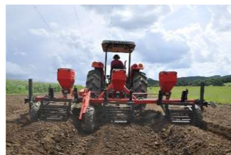
Camalhão alto de base larga em construção com arado aleirador borboleta equipado com rolo condicionador do camalhão. Foto: Horácio Azevedo Bueno
