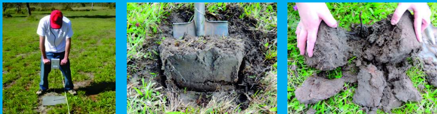
Determinação do grau de degradação física do solo, identificada por meio da compactação do solo. À esquerda, com uso de penetrômetria, e à direita, com o DRESS.
