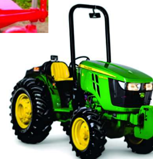
Roçadora com proteção de cardã, colhedora de grão com tração traseira auxiliar - TTA e trator com equipamento de proteção contra capotamento
