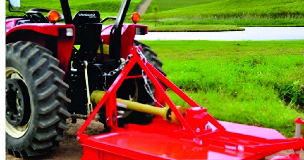
Roçadora com proteção de cardã, colhedora de grão com tração traseira auxiliar - TTA e trator com equipamento de proteção contra capotamento
