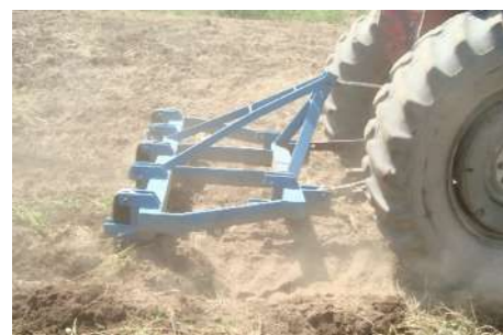
Escarificação do solo precedendo a implementação de camalhões altos de base larga vegetados. Foto: Horácio Azevedo Bueno
